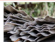
Les plaques de fibrociment ou autre composant contenant de l'amiante.
